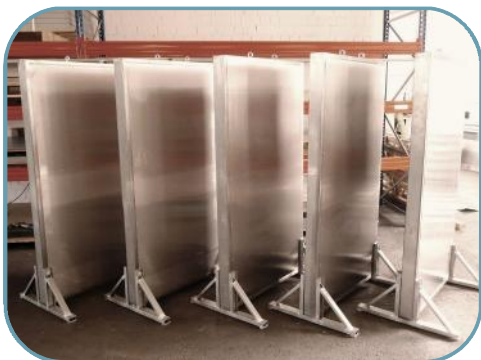
Hitzeschutzwände mit Ringösen für Krantransport
