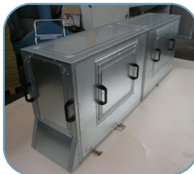
Lärmschutzhaube einer Sortieranlage für Schrauben
