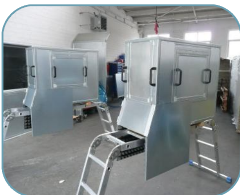
Lärmschutzhaube einer Sortieranlage für Schrauben
