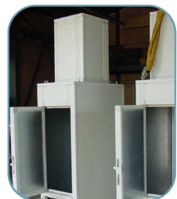
Lärmschutz für Test von Schlagschraubern
