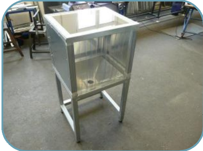
Ausblasbox auf Gestell, lärmgedämmt mit Absauganschluss und Glaseinsicht
