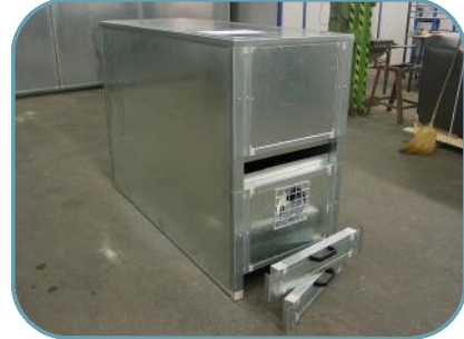
Lärmschutzbox für Kompressor mit Be- und Entlüftung
