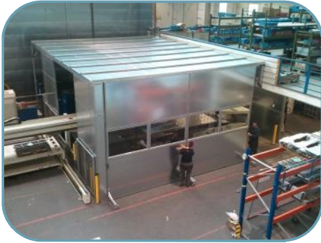
Kabine für Stanzanlage mit fahrbaren Wänden geschlossen
