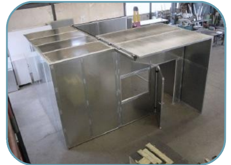
Kabine mit Winkelschiebetüren für großzügigen Dachzugang
