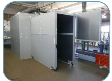
Kabine für Schreddermühle mit angeschlossenem Zuführtunnel
