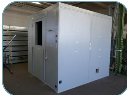
Kabine für Schreddermühle mit Tunnelanschluss
