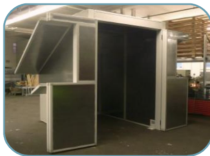
Kabine für Schreddermühle mit Zuführtunnel offene Tür
