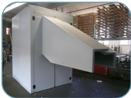
Kabine für Schreddermühle mit integriertem Zuführtunnel
