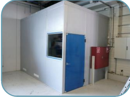
Lärmschutz für Schusstest mit Abluft nach Außen
