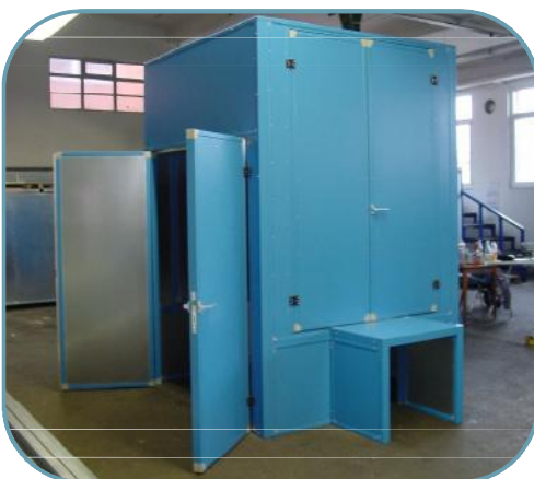
Lärmschutzkabine mit großzügigen Zugängen und Ein- bzw. Auslaufunnel
