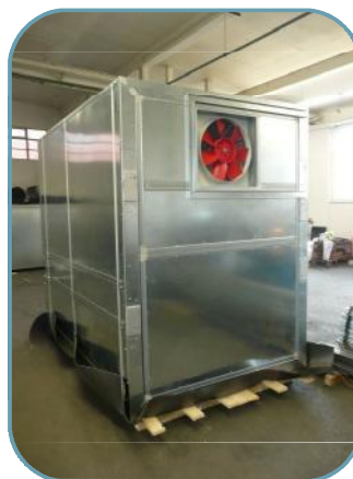
Lärmschutzkabine mit Abluftsystem
