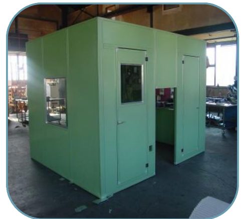
Arbeitsschutzkabine mit Fenster div. Durchbrüchen
