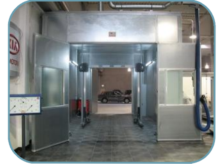
Lärmschutzkabine für Abgastest mit großzügigen Flügeltüren Wandstärke 110 mm
