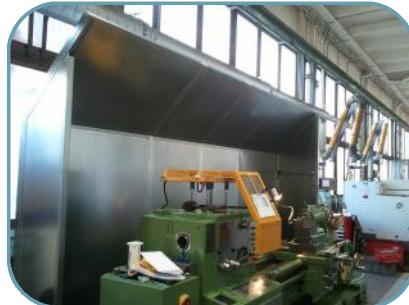
Lärmschutzumhausung für Drehmaschine
